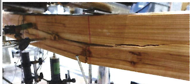
図-2 梁の破壊状態(Type-B-GFRP-1)
